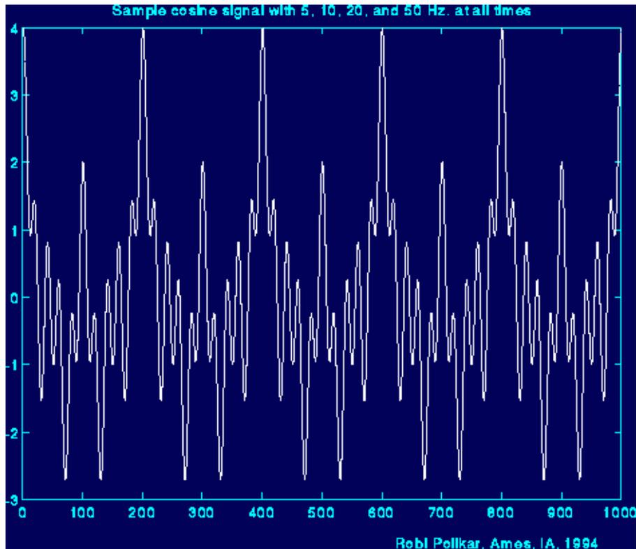
Figure 12: Forma de onda compuesta por 4 componentes
